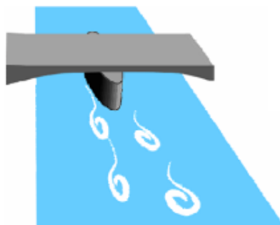
Abbildung 7-12: Wirbelablösung hinter einem Brückenpfeiler (Grafik: Wikipedia)
