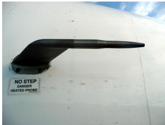
Abbildung 7-8: Pitot-Sonde an einem Flugzeug.
