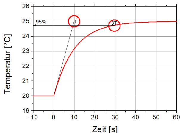
Abbildung 2-17: berechnetes Verhalten eines Temperatursensors bei schlagartiger Erhöhung der Umgebungstemperatur um  $5^\circ\text{C}$
