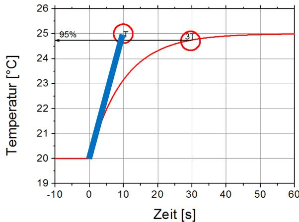
Die blau eingezeichnete Tangente entspricht genau der oben betrachteten einfachen Vorstellung dass der Wärmestrom  $\dot{Q} = h \cdot A \cdot \Delta T$  konstant ist – dann steigt die Temperatur einfach linear an bis die Umgebungstemperatur erreicht ist. Um nun auch noch die rote, echte Kurve berechnen zu können müssen wir eine Differentialgleichung aufstellen! Dies erfordert ein bisschen Aufwand, aber Sie werden sehen dass es sich lohnt!
