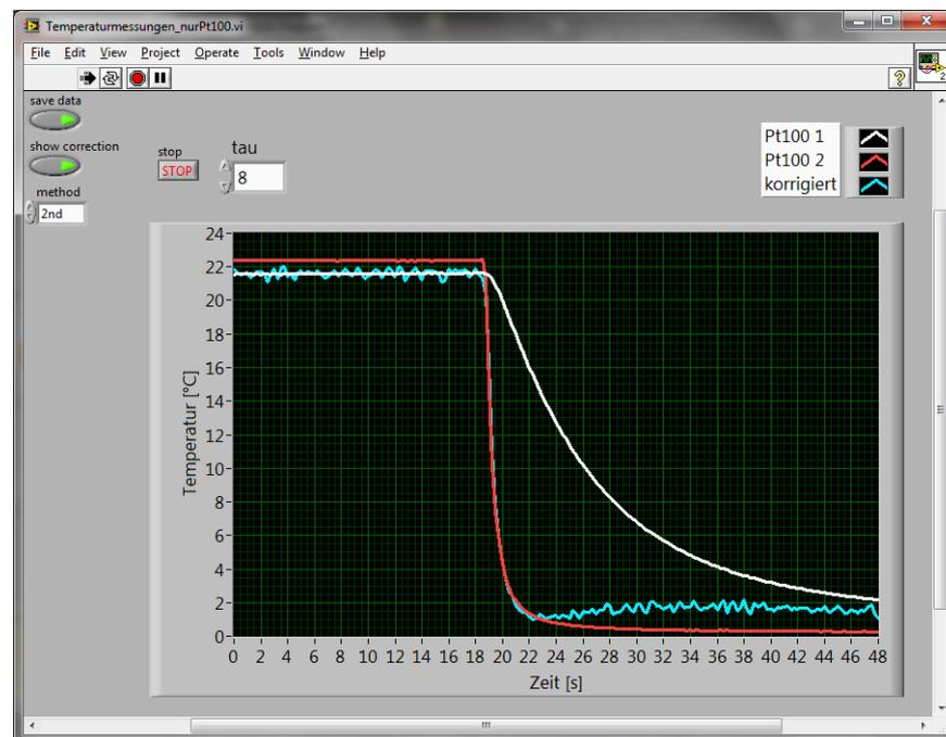
**Abbildung 2-19: Langsames Pt100 (weiss) mit Differentialgleichung beschleunigt (hellblau)**
