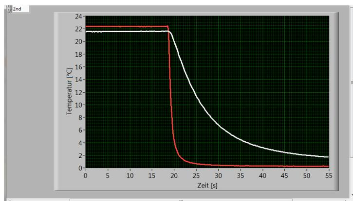
**Abbildung 2-16: gemessenes Verhalten von 2 Temperatursensoren beim Eintauchen in Eiswasser**
