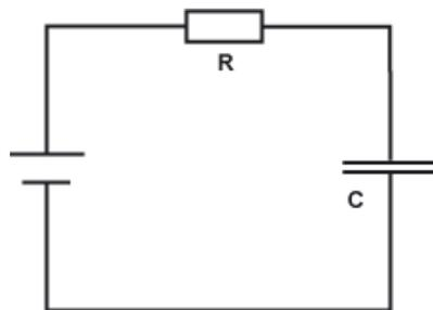
Wie lange dauert es bis der Kondensator geladen ist, bzw. wie ist der Verlauf der Spannung  $U(t)$  am Kondensator?
