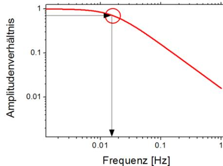
**Abbildung 2-18: Frequenzgang eines Sensors, simuliert**
